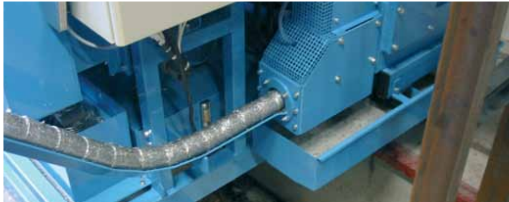
Brikettauswurf mit Schienenfördersystem und KSS Auffangwanne Briquet discharge with briquet conveying system and sump for CCFs
